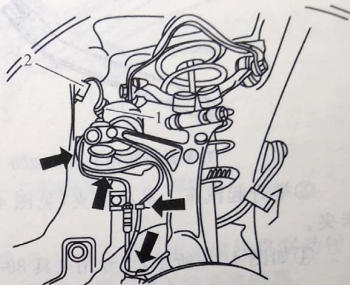
图 4-8 拆卸前轮转速传感器导线 1—车轮罩套; 2—转速传感器导线插头
